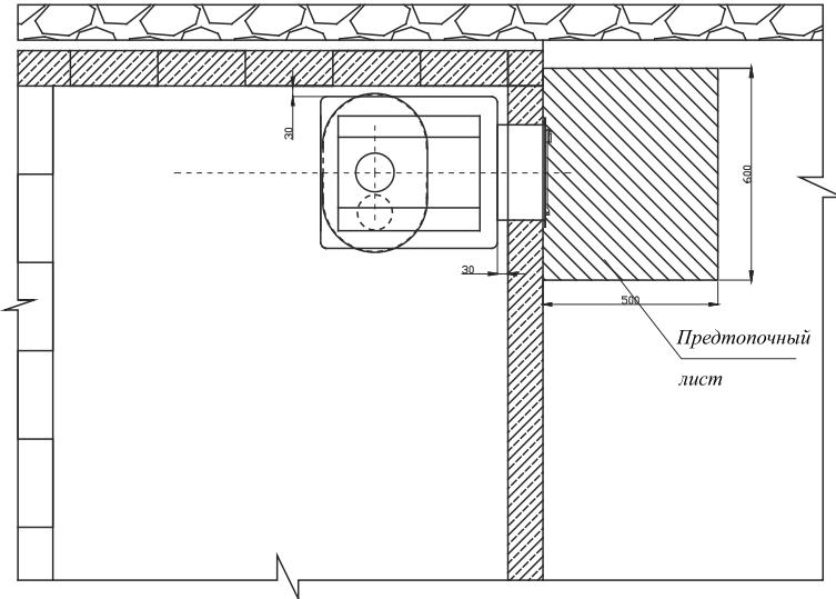
**Схема монтажа печи**
