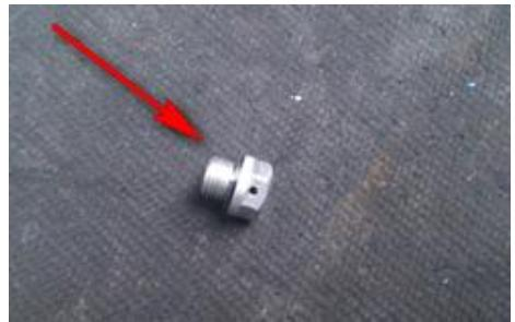
Вкрутить его в корпус редуктора на место вывернутой пробки - заглушки
